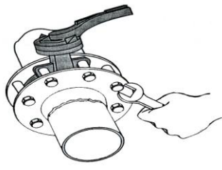
۹- بقیه پیچ و مهره را بسته و آنها را بطور ضربدری سفت نمایید.
