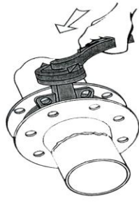
۶- پس از سرد شدن فلنج ها ، شیر را بین آنها قرار دهید. در این حالت شیر باید به آسانی بازو بسته شود. برای آنکه لاستیک آببندی صدمه نبیند قدری آن را در حالت باز نگهدارید.
